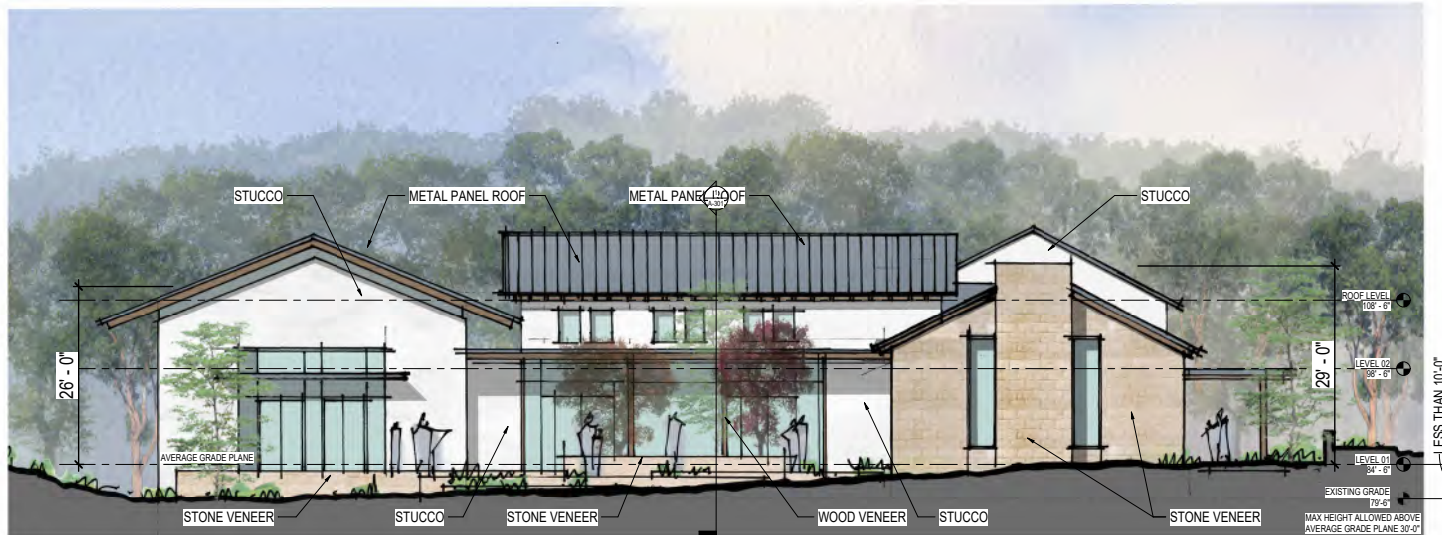
2 EXTERIOR ELEVATION - EAST SCALE: 1/8" = 1'-0"
