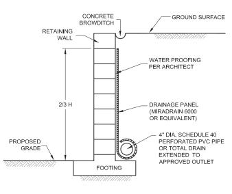
TYPICAL RETAINING WALL DRAIN DETAIL
